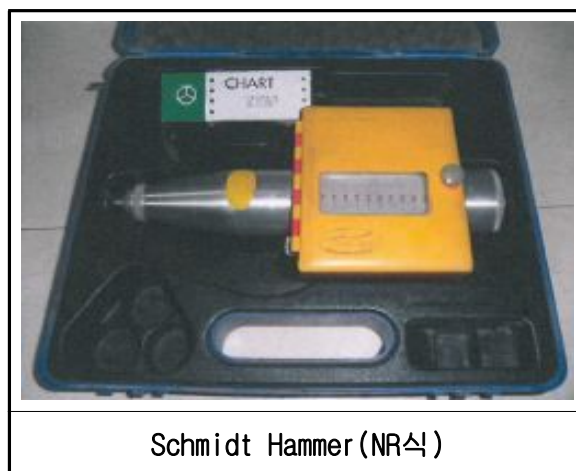
【그림 3.23】 콘크리트 반발경도 측정장비(Schmidt Hammer)
